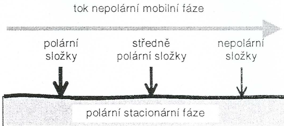
Obr. 62 Schéma interakcí v rozdělovací kapalinové chromatografii (Zdroj: P. Klouda, Moderní analytické metody )
