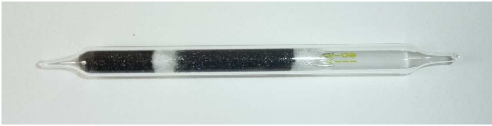
Obr. 6 Skleněná trubice naplněná aktivním uhlím pro záchyt organických látek
