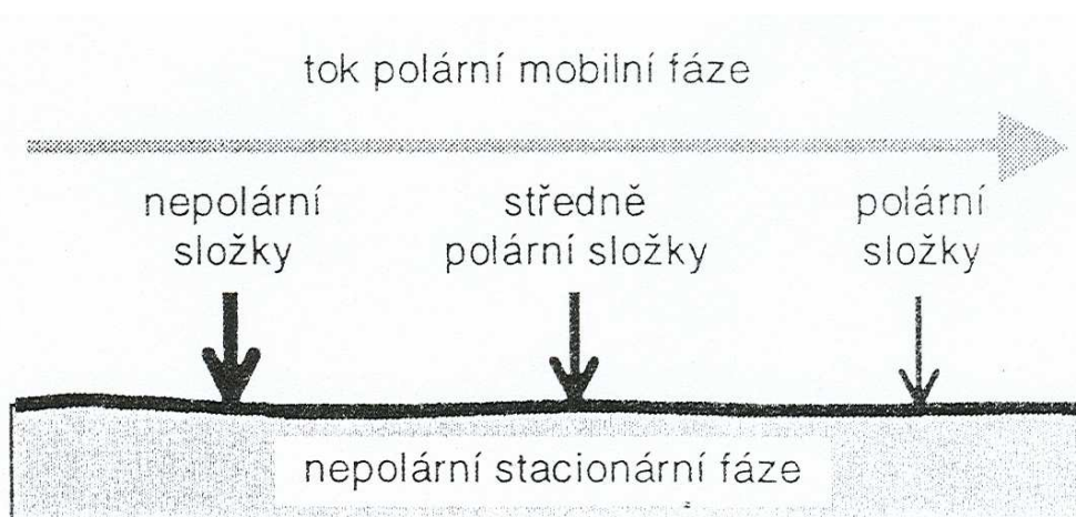
Obr. 63 Schéma interakcí v rozdělovací kapalinové chromatografii (Zdroj: P. Klouda, Moderní analytické metody )
