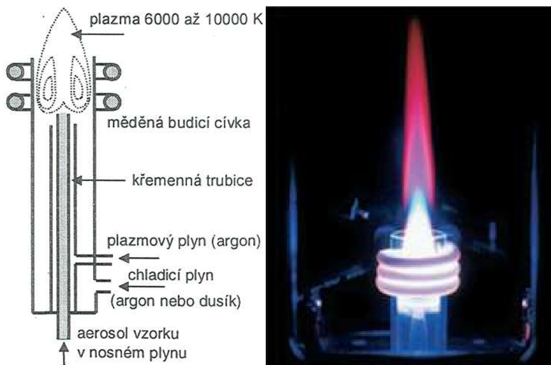
Obr. 50 Plazmová hlavice ICP (schéma zdroj - P. Klouda, Moderní analytické metody, reálný obrázek zdroj - Analytikjena prezentace firem)
