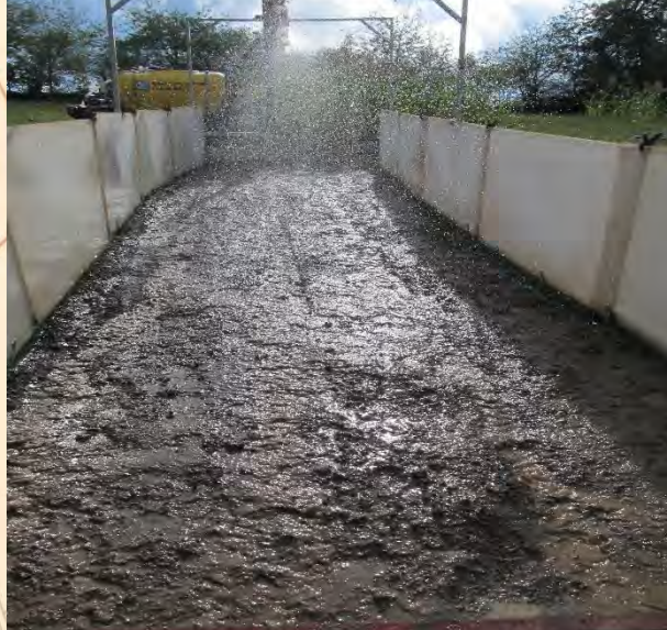
Obr. č. 3 Simulace srážek na jednotlivých variantách, vlevo varianta V1 (úhor bez předdeště) a vpravo varianta V2 (úhor s předdeštěm), přirozený vlhkostní stav
