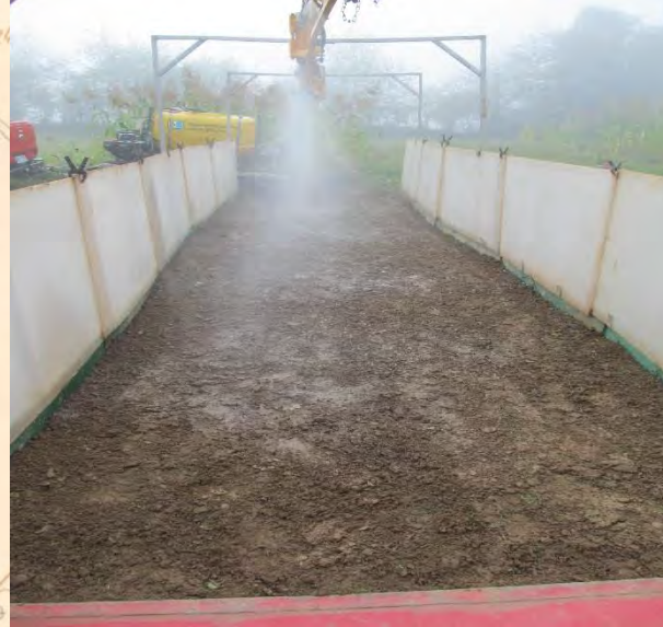
Obr. č. 3 Simulace srážek na jednotlivých variantách, vlevo varianta V1 (úhor bez předdeště) a vpravo varianta V2 (úhor s předdeštěm), přirozený vlhkostní stav
