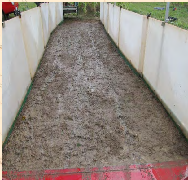
Obr. č. 4 Simulace srážek na jednotlivých variantách, vlevo varianta V1 (úhor bez předdeště) a vpravo varianta V2 (úhor s předdeštěm), po nasycení
